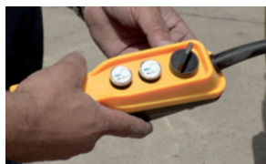
Afstandsbediening met een elektrisch besturingssysteem aangesloten op de accu van het voertuig
